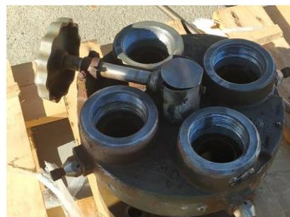
Dispositivo soporte multiválvulas de seguridad para recipiente de NH<sub>3</sub>.
