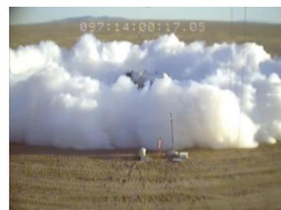
En condiciones ambientales de estabilidad atmosférica y relativamente poca humedad, se observa el diferente comportamiento entre la nube de cloro y la de amoniaco. La del cloro es una nube delgada y a ras de suelo, mientras que la del amoniaco es muy voluminosa y se dispersa rápidamente en todas direcciones.
