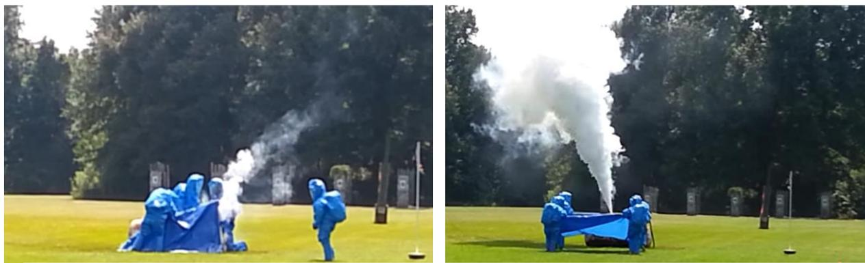
Cubrición de un depósito presurizado de amoniaco anhidro fugando en fase gas. TRANSCAER
