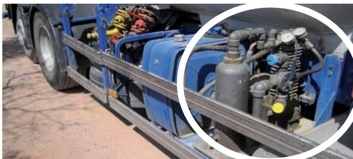
Antes de realizar el montaje de la figura, se tienen que equilibrar las presiones entre ambas cisternas. Únicamente hace falta conectar las fases líquidas:
