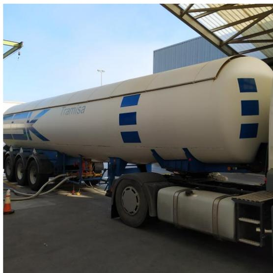
Cisterna con parasol realizando operaciones de descarga.
