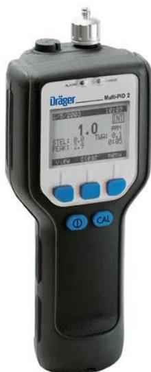
La detección que realizan los PID's se basa en el fenómeno de ionización. Cuando una muestra de gas absorbe energía de una lámpara PID, el gas se estimula y su contenido molecular se altera, perdiendo el compuesto un electrón (e-) y se convierte en un ion con carga positiva, quedando la sustancia ionizada.
