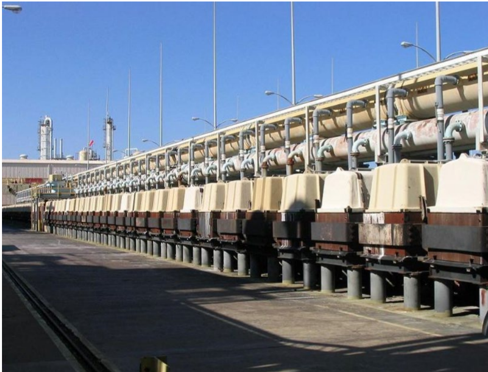
Dispositivo de celdas de diafragma
