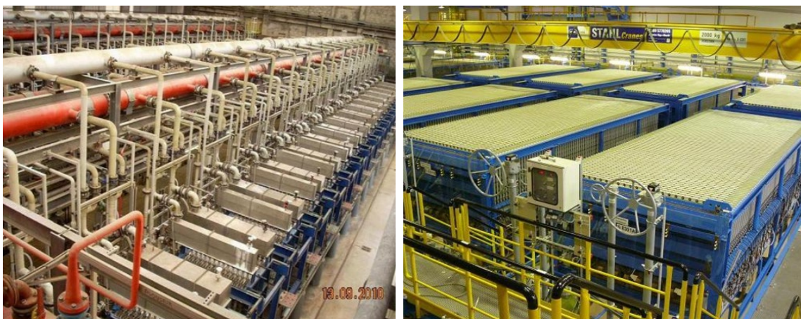
Dispositivo de celdas de membrana – monopolar (izda) – bipolar (dcha) Fuente: Solvay 2010 (izda), Vinnoli 2011 (cha)
