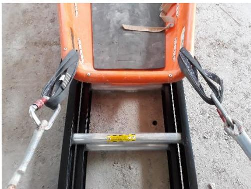
Por otro lado, se cogen las otras dos cintas y se pasan por los puntos de anclaje o sujeción de que dispone la camilla en la zona de la cabeza, se alondrará a la camilla con la cinta de 120cm en doble como se aprecia en la imagen siguiente. Dejamos así preparada la camilla para la Maniobra.
