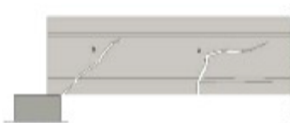
Fuente: IVE Por agotamiento por tracción de la armadura transversal.
