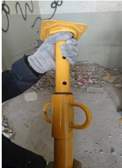
Detall de la rosca vista abans de desplegar el puntal
