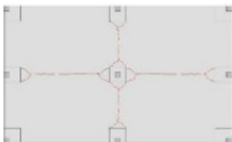
Font: IVE Lesió en forjat reticular per falta de resistència a flexió cara superior i inferior
